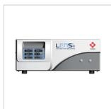
MALS-Detektor # Direkte Charakterisierung von Makromolekülen bis 2 nm Rg # Hochempfindlich dank grünem Laser # Koppelbar mit HPLC und UHPLC #...
