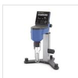
Die neue Viskosimeterserie ROTAVISC bestimmt die Viskosität von Flüssigkeiten in allen Anwendungsbereichen vom Labor bis zur Qualitätskontrolle...
