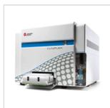
Kompaktes Durchflusszytometer # Flexibel & erweiterbar # Bis zu 23 Parameter # Misst bis zu 30.000 Ereignisse/Sekunde # 6 verschiedene Wellenlängen #...
