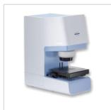
LUMOS ist ein vollautomatisiertes FTIR-Mikroskop. Es genügt höchsten Ansprüchen bei der visuellen Betrachtung und der IR-spektroskopischen Analyse...
